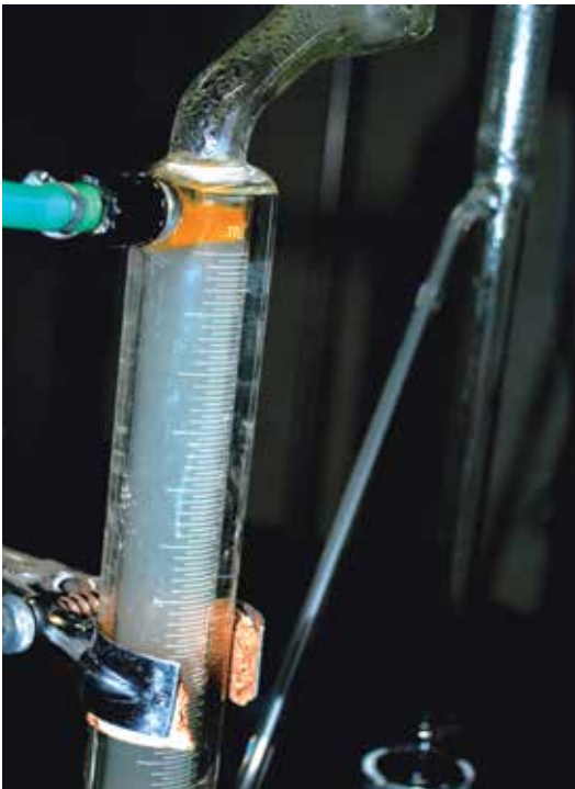
Fig 1 - La distillazione in corrente di vapore consente di separare l'olio essenziale (in alto) dall'idrolato (o acqua aromatica) (in basso).
