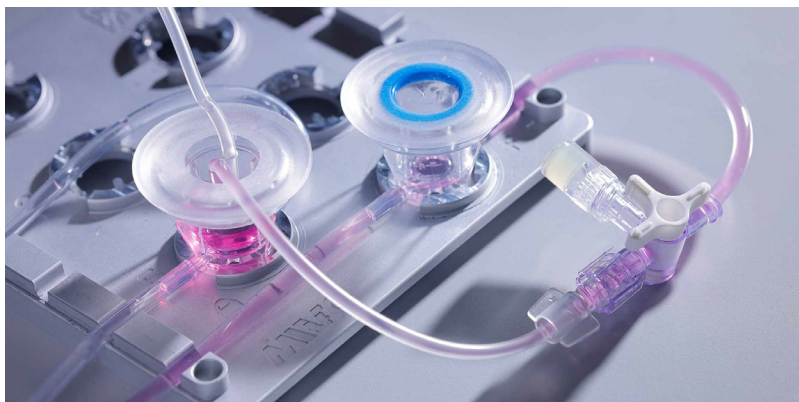
Fig. 1 L'apparecchio MIVO® (Multi In Vitro Organ), usato per i test in laboratorio.
